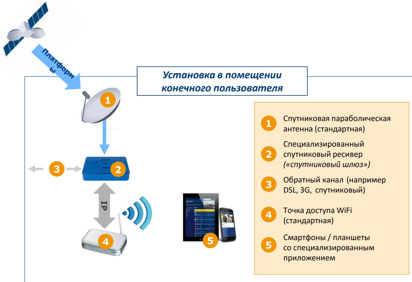
ТВ-каналы и контент по запросу в формате IP принимаются со спутника в многоадресном режиме
